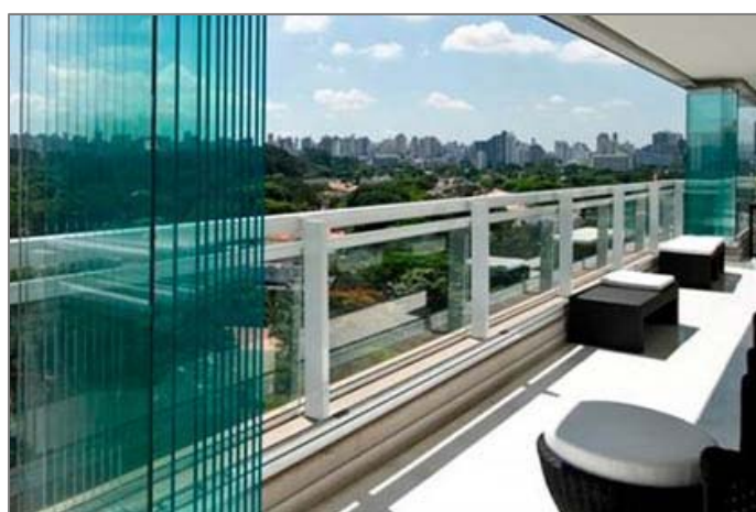
Рис. 1. Система остекления «Книжка»
