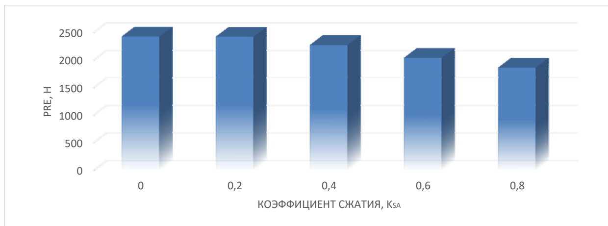
Рис. 4. Влияния геометрических параметров каменистого включения на силу сопротивления грунта резанию
